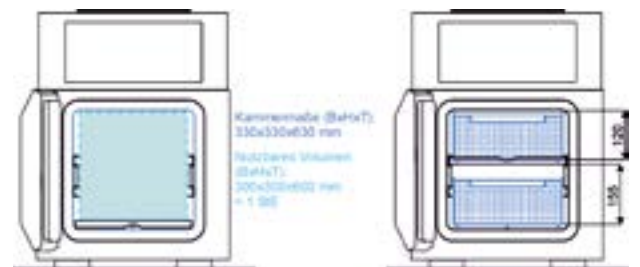
BlueLine 65 T: Verwendung von Gitter-Einsatzkörben, kubisch [mm]
