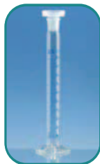
Mischzylinder, Klasse A Boro 3.3, DIN EN ISO 4788, PP-Stopfen, Sechskantfuß, Justiert auf IN, blaue Graduierung
