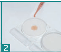
2 1ml Probe mittig auf das CompactDry geben
