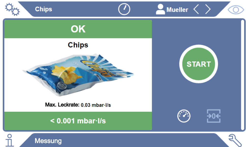
Abb. 3: Grün unterlegte Messanzeige bei Prüfobjekt ohne Beanstandung
