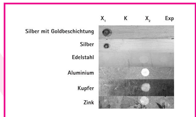
Abb. 3. Korrosives Potenzial konventioneller DNA-Dekontaminationsmittel im Vergleich mit DNA-ExitusPlus™. Metalle, wie sie üblicherweise für Laborausstattungen oder Geräte verwendet werden, wurden 20 Minuten mit den Lösungen inkubiert. Kontrolle (K) mit sterilem Wasser; X 1 , X 2 (Wettbewerbsprodukte). Exp (DNA-ExitusPlus™).
