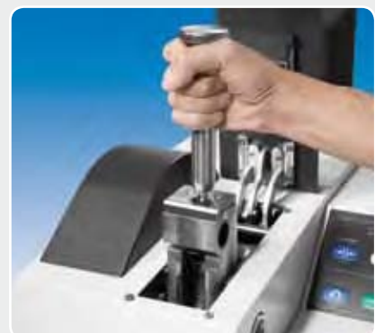
Einfache Entnahme des vorderen Brecharms ohne Werkzeug
