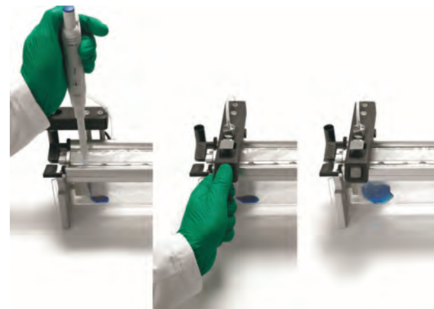
Bild 1: Automatische Verdünnung in Inlabtec Serial Dilution Bags. Die Probe wird mit der Pipettenspitze in den Beutel abgegeben und der Dosierarm wird nach vorne geschwenkt. Per Tastendruck strömt die Verdünnungslösung präzise durch die Spitze in den Beutel. Dabei entsteht ein intensiver Wirbel, der zusammen mit einem sterilen Luftstoß für eine homogene Mischung in <4 s sorgt. (s. dazu Videos auf der Herstellerwebsite). (Bild: Inlabtec)
