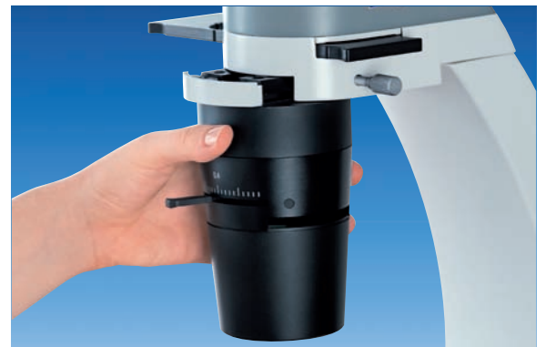
Größerer Arbeitsabstand durch leichtes Entfernen des Kondensors, z.B. für die Arbeit mit Rollerflaschen.
