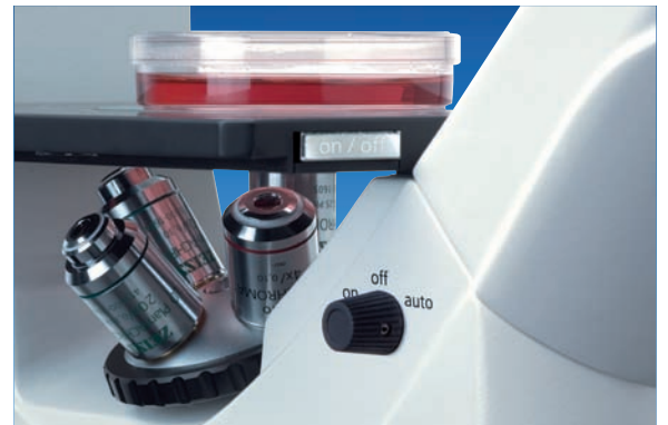
Leichte Bedienbarkeit: Walk-Away-Modus und Lichtschalter am Stativ erleichtern das Arbeiten bei der Prüfung lebender Zellen wesentlich.
