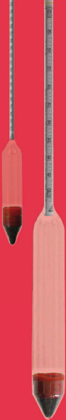
Aräometer mit Thermometer oben Hydrometers with Thermometer in the Upper Part
